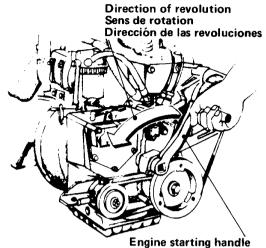
Engine starting handle Poignée de mise en route du moteur Palanca de arranque del motor
