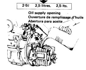
Oil gauge rod Jauge de niveau d'huile Varilla del medidor de aceite Upper limit Repère supérieur Límite superior
