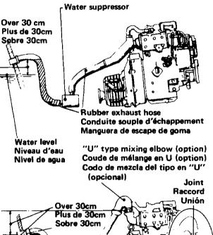
Add joints so that the measurements comply with those shown above. Ajouter des raccords pour être conforme aux mesures indiqueés ci-dessous. Agregar uniones para complir con las medidas que se muestran en el dibujo a continuación.
