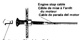
Engine stops if knob is pulled Le moteur s'arrête que lorsque le bouton est repoussé Si se tira de la perilla se detiene el motor
