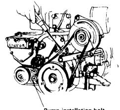
Pump installation bolt Boulon de fixation de pompe Pernos de instalación de la bomba 4) Au moment du remontage de la turbine, l'orienter dans le sens indiqué sur la photographie supérieure droite.
